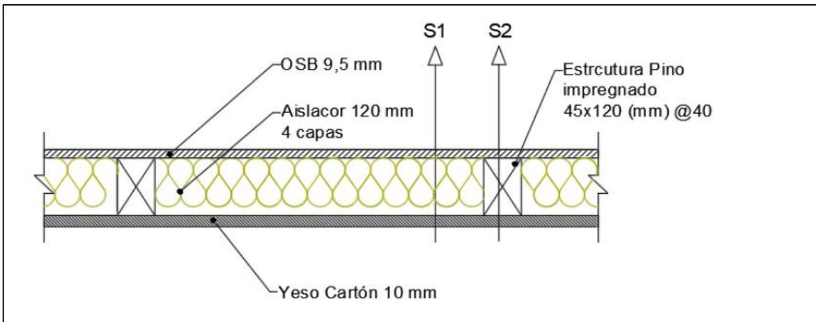
**Figura 2. Esquema general de muro a asimilar**
