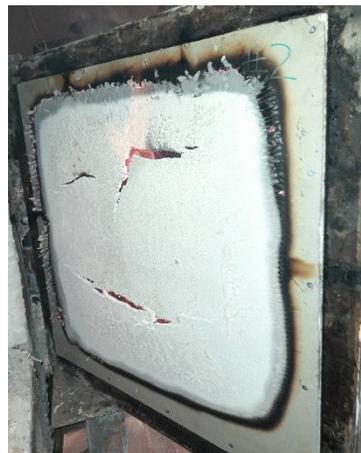
*Figura 15. Vista de la probeta N°2 por la cara expuesta al fuego, al término del ensayo.*
