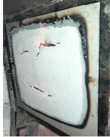
Figura 15. Vista de la probeta N°2 por la cara expuesta al fuego, al término del ensayo.
