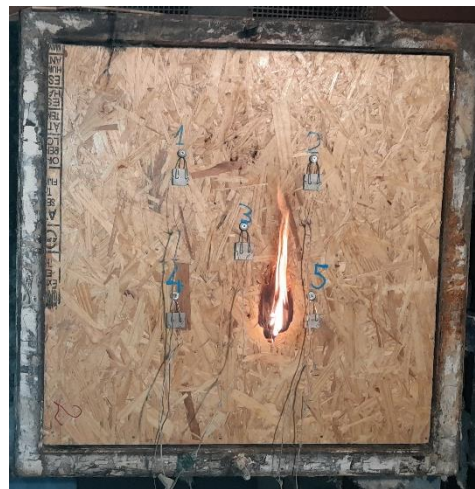
Figura 13. Vista de la probeta N°2 por la cara no expuesta al fuego, al término del ensayo.
