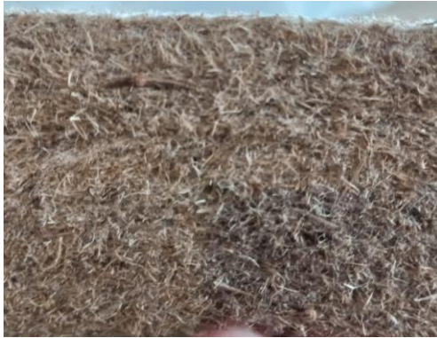
Figura 6. Vista canto aislante térmico de la Probeta N°1 (Panel de fibras naturales)
