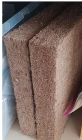
*Figura 7. Vista general aislante térmico de la Probeta N°1 (Panel de fibras naturales)*
