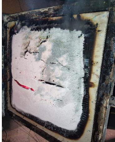
Figura 14. Vista de la probeta N°1 por la cara expuesta al fuego, al término del ensayo.
