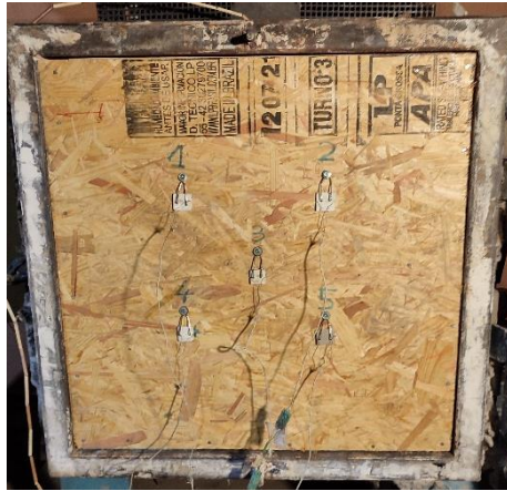
Figura 10. Vista de la probeta N°1 por la cara no expuesta al fuego, montados los cinco termopares antes del ensayo.
