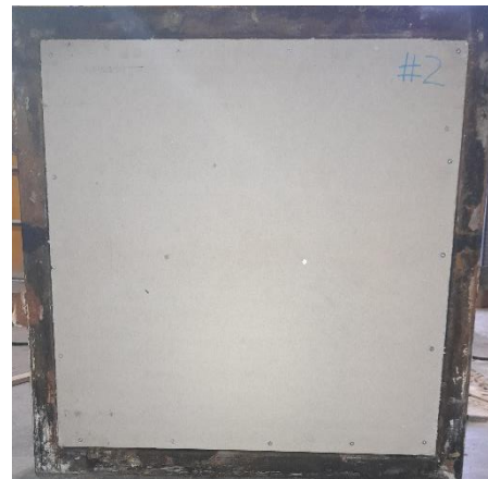
Figura 9. Vista de la probeta N°2 antes del ensayo, cara expuesta al fuego.
