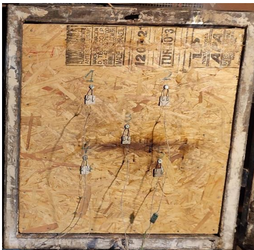
Figura 12. Vista de la probeta N°1 por la cara no expuesta al fuego, al término del ensayo.
