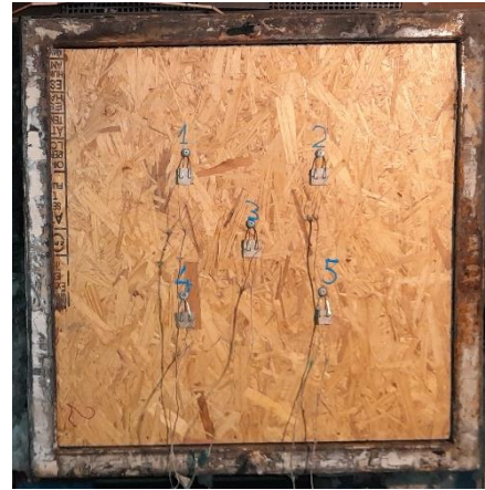
Figura 11. Vista de la probeta N°2 por la cara no expuesta al fuego, montados los cinco termopares antes del ensayo.
